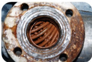
Widok rurek wymiennika typu JAD przed chemicznym oczyszczeniem – osady żelaziste
