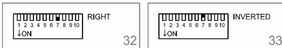
Rys. 32 - 33 Kierunek obrotów: 32 – w prawo (np. 0-10V → 0-90°), 33 – w przeciwnym kierunku (np. 0-10V → 0-90°)
